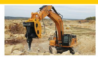
Основным назначением оборудования являются вскрышные работы, разработка средних и тяжелых грунтов с высокой степенью трещиноватости: песчаник, уголь, сланец, гипс, известняк. Виброрыхлители также применяют для вскрытия искусственных покрытий, таких как асфальт, бетон, и рыхления мерзлого грунта.
