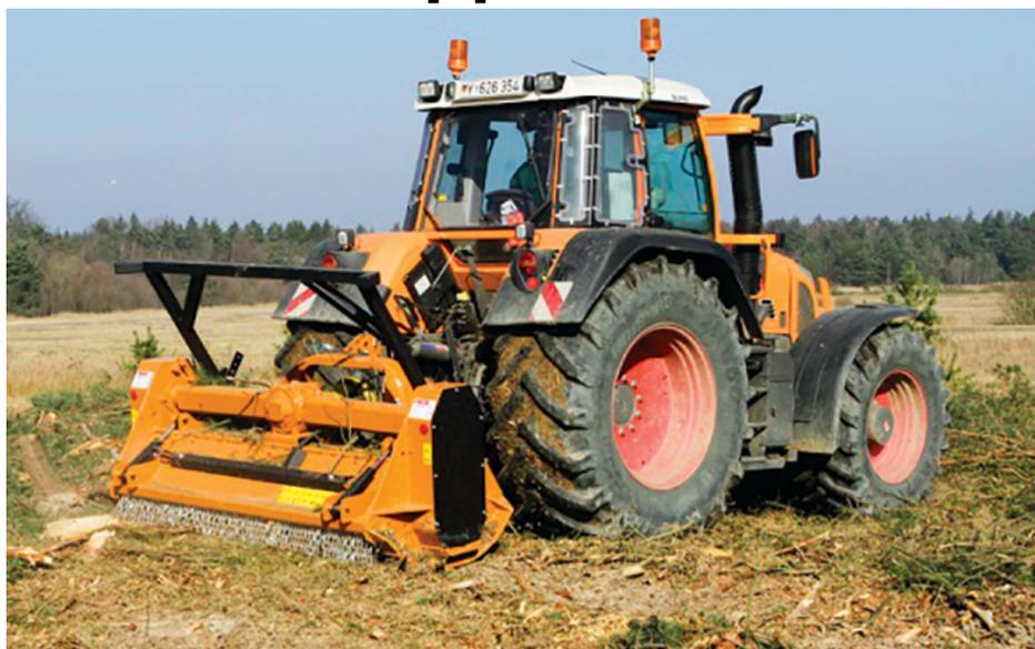
Мульчеры для тракторов с ВОМ применяются для сплошного мульчирования больших площадей. Удаление травы на технике с двигателем от 12 л.с. или работа в лесу с древесиной до 350 мм при мощности двигателя до 250 л.с. — нашему оборудованию под силу абсолютно все.
