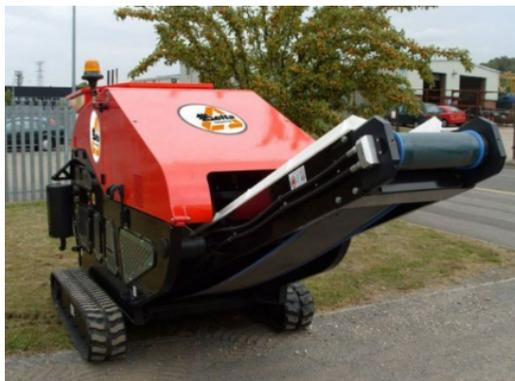
5000 Plus аналогичен стандартному 5000, но с дополнительной функцией вибропитателя. Это дополнение имеет гидравлический привод и управляется пультом дистанционного управления.
