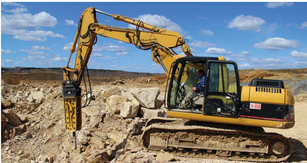
Гидромолоты средней серии используются при строительстве и демонтаже опор мостов, сносе сооружений при больших объемах работ.
