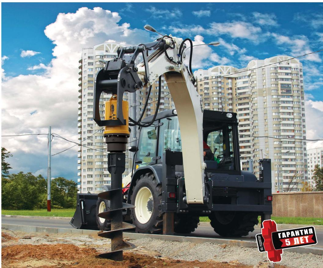
Гидравлические ямобуры – один из самых популярных видов сменного навесного оборудования. Гидровращатели Delta нашли свое применение в широком спектре задач – установка ограждений и опор ЛЭП, монтаж уличного освещения и дорожных знаков, бурение скважин под сваи и завинчивание винтовых свай, бурение под колодцы и для пересадки деревьев, бурение скважин прочих технологических назначений.
